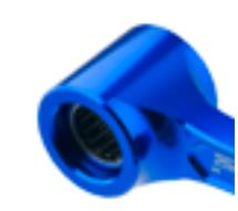
▲車種に合わせて設計されたボルトオン設計で、純正のリンクと交換するだけで取付け可能。ペアリング圧入済み。
